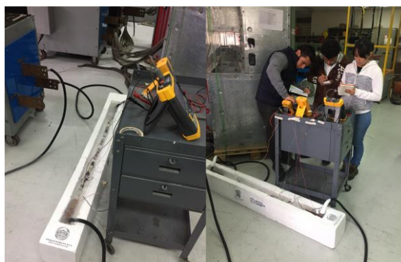
Fig. 8. Prueba del cable HTS en el LAPEM a 1200 A.
