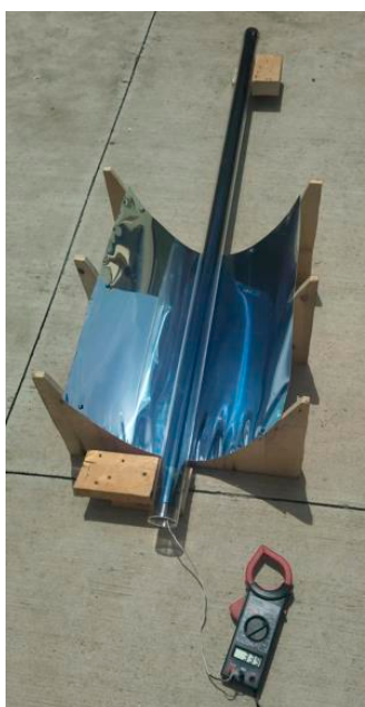
Fig. 13. Medición de temperatura en tubo de vacío en perfectas condiciones en cocina solar.
