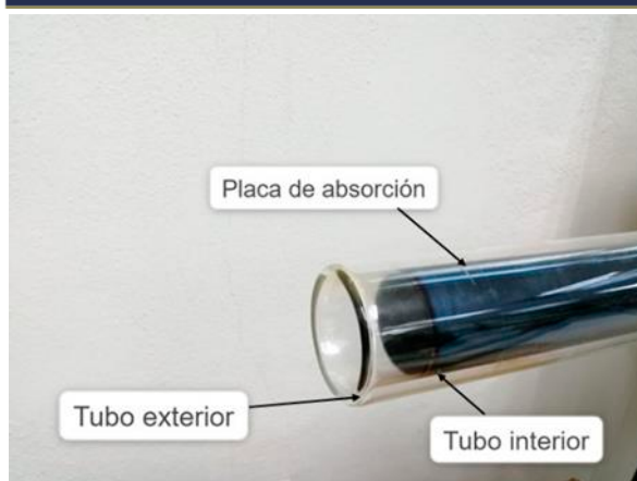
Fig. 2. Partes de un tubo de vacío.
