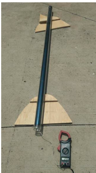
Fig. 12. Medición de temperatura en tubo de vacío en perfectas condiciones.
