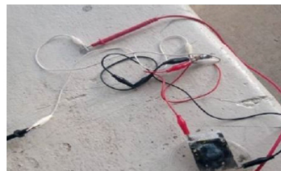
Fig. 3. Medición de la corriente y voltaje de la celda orgánica.
