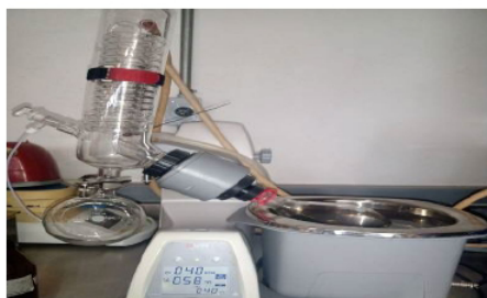
Fig. 2. Destilación de exceso de líquido del tinte.
