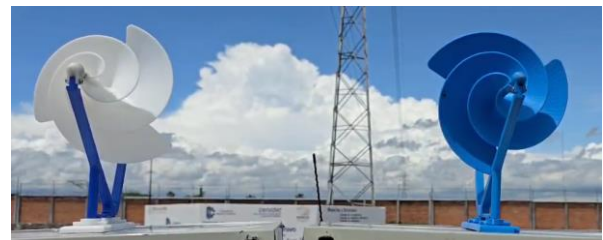
Fig. 16. Pruebas experimentales de ambos diseños de rotor del aerogenerador ASWT.
