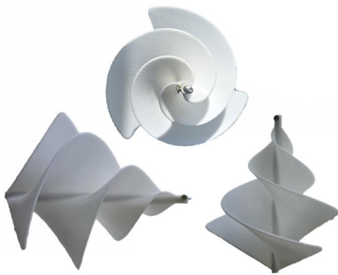
Fig. 13. Modelo del rotor del aerogenerador propuesto en impresión 3D.
